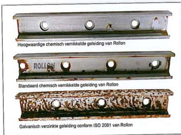
Afbeelding 2. 360 uur in een zoutspoeitest – 15 dagen de klok rond – laten op de hoogwaardig chemisch verzinkte geleidingen slechts beperkt sporen achter. Ook de andere Rollon geleidingen doorstaan de testcyclus.
