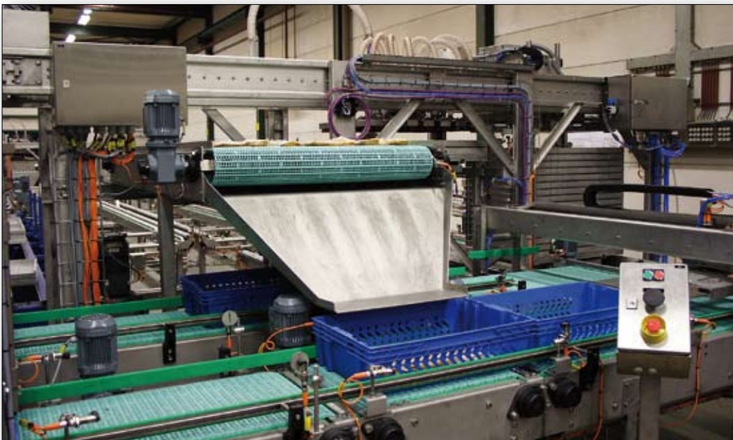
Afbeelding 1. In deze machine worden maaltijdverpakkingen getransporteerd naar een sterilisatiemachine. Om de hoge krachten en momenten te kunnen verwerken, is gebruikgemaakt van twee Rollon Compact Rails. In het zogenoemde K+U systeem kunnen deze geleidingen hoekverdraaiingen en breedteverschillen tot een bepaald maximum overbruggen. Bron: LAN Handling Systems
