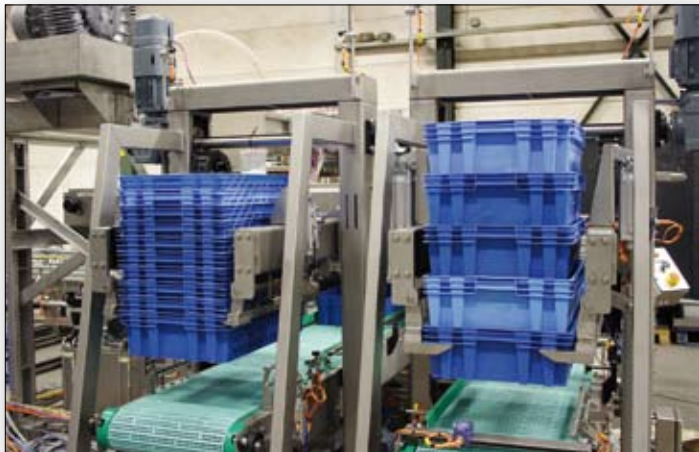
Afbeelding 2. De verticale bewegingen van de trays worden voor rekening genomen van een hydraulisch systeem.
